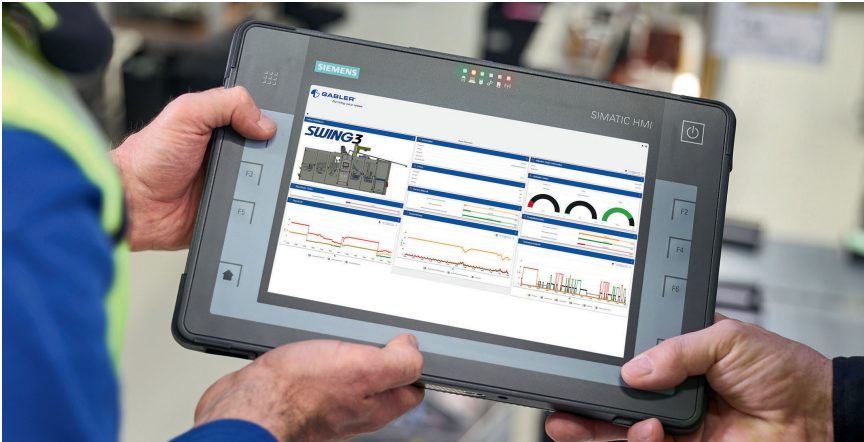
Bild 3. Tragbares Comfort Panel: Das gemeinsam mit Siemens entwickelte Gabler-Dashboard visualisiert über das offene, Cloud-basierte Softwaresystem MindSphere Maschinen- und Prozessdaten © Siemens
